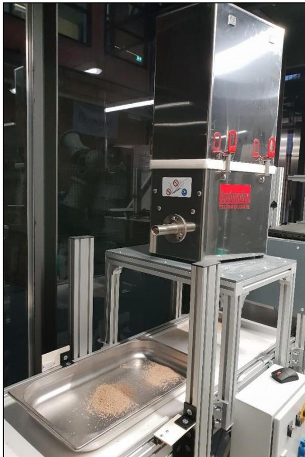
**Abbildung 13: Automatischer Futterautomat von Brabender zur Befüllung der Aufzuchtbehälter der Larven mit Weizenkleie**
