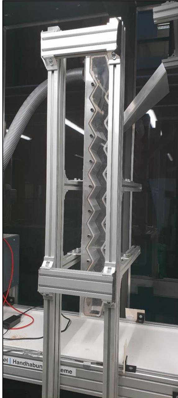
**Abbildung 12: Kombination aus Zick-Zack-Sichter und Fließband aus Aluminium-Item Profilen**
