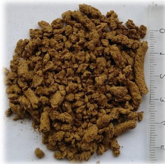
Abbildung 34: Presskuchen nach dem Austritt aus der Seiherschneckenpresse
