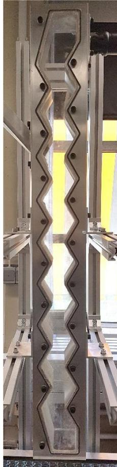
**Abbildung 9: Fertiger Zick-Zack-Sichter mit 17 Trennstufen**
