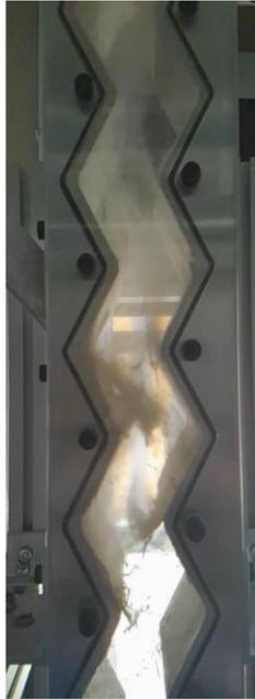
**Abbildung 11: Zick-Zack-Sichter im Betrieb. Hervorzuheben ist hierbei die Abnahme des Feingutanteils im Grobgut mit steigender Stufenzahl**
