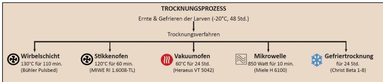
**Abbildung 8: Darstellung des Trocknungsprozesses mit den verschiedenen Trocknungsverfahren.**
