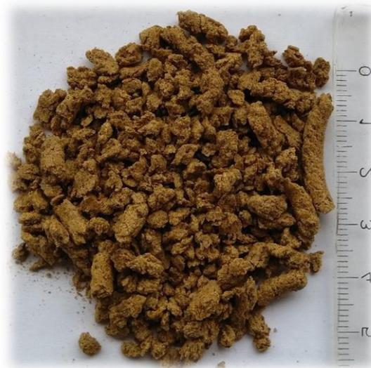
**Abbildung 29: Presskuchen nach dem Austritt aus der Seiherschneckenpresse**
