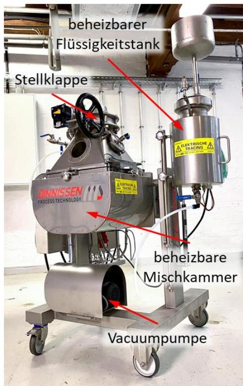
**Abb. 3:** Laborvakuumcoater der Firma DINNISSEN
